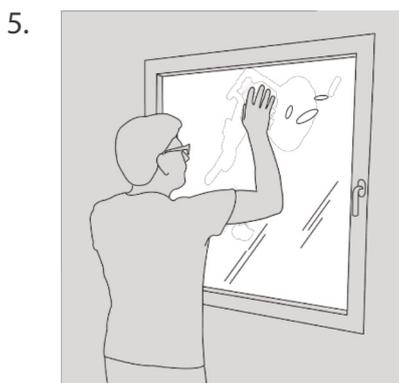
Die Textilgewebefolie wieder leicht auf das Fenster anbringen, während das Gewebe mit der Hand oder dem Montagerakel angestrichen wird.
