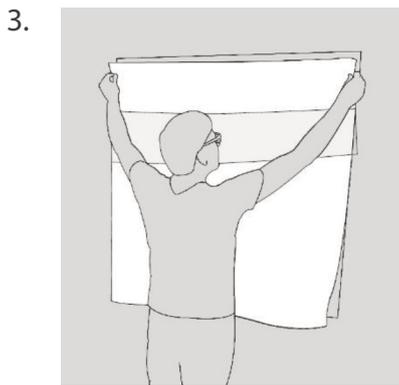
Die Textilgewebefolie oben am Fenster in den Ecken genau ausrichten und anbringen. Dabei mit leichtem Druck auf die Glasfläche andrücken.
