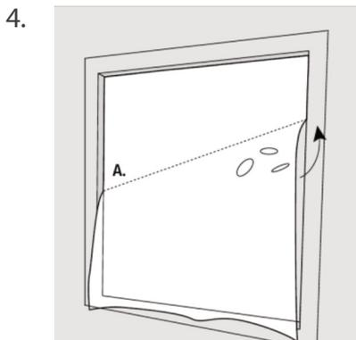
Sollte es zu Blasen oder Falten kommen, die Textilgewebefolie ohne Spannung nach oben ablösen, bis der Bereich der Blasen oder Falten gelöst ist (A).
